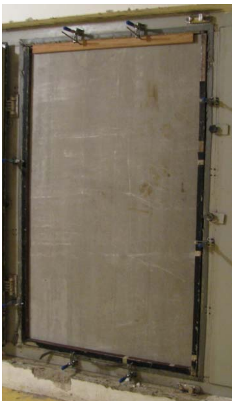
Figura 4: Fotografia da amostra de 75 mm de espessura sendo ensaiada. Vista frontal.
