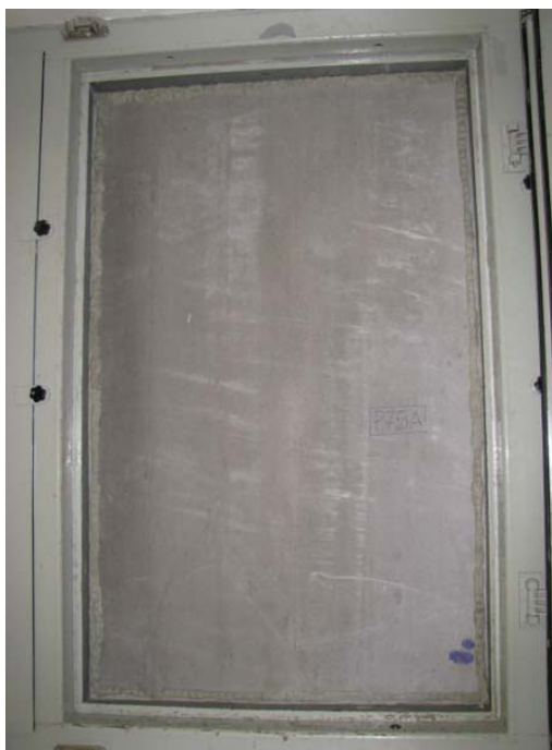
Figura 5: Fotografia da amostra de 75 mm de espessura sendo ensaiada. Vista traseira.
